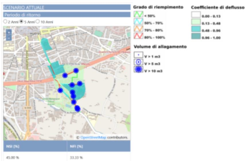
Figure 10: Carte de l'état actuel du risque hydraulique pour le cas d'étude Bassin Est Avenue Ambroise Thomas et indicateurs de la fonctionnalité du réseau de drainage (NSI - Network Stress Index ; NFI - Node Flooding Index) pour l'événement du projet avec une période de retour de 5 ans. En haut à droite se trouve la légende des éléments (niveau de remplissage des conduites et coefficient d'écoulement des sous-bassins) indiqués sur la carte.
