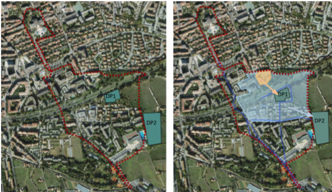
Figure 16: Retour dans la plateforme TRIG Eau du système de bassins de rétention (à gauche) à mettre en place dans le bassin Est de l'Avenue Ambroise Thomas avec les zones contributives correspondantes (à droite).
