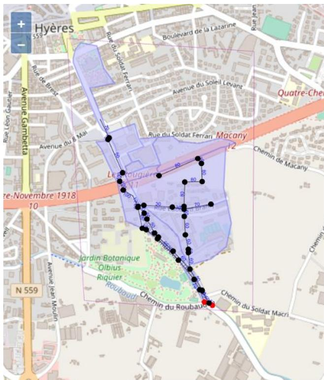
Figure 8: Implémentation dans la plateforme TRIG Eau du cas d'étude Bassin Est Avenue Ambroise Thomas. Indication des sous-bassins (polygones bleus) et du système de drainage des eaux de pluie (ligne noire), y compris les valeurs des diamètres en cm (étiquettes bleues) et des pentes (étiquettes noires) de chaque branche.
