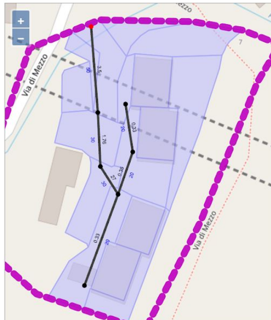
Figure 9: Implémentation dans la plateforme TRIG Eau du cas pilote de Via Figari. Indication des sous-bassins (polygones bleus) et du système de drainage des eaux de pluie (ligne noire), y compris les valeurs des diamètres en cm (étiquettes bleues) et des pentes (étiquettes noires) de chaque branche.
