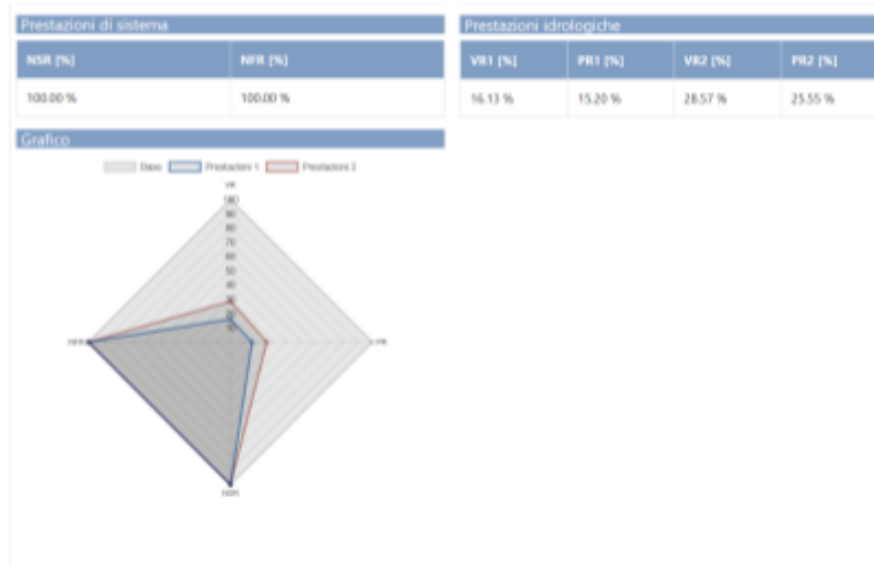
Figura 27: Performance du système (NSR - Network Stress Reduction et NFR - Node Flood Reduction), performance hydrologique (VR - Volume Reduction et PR - Peak Flow Reduction) et graphique radar correspondant dans le scénario "systèmes secs" pour le cas d'étude de Via Grazia Deledda objet de l'intervention COLANDER et pour l'événement du projet avec une période de retour de 10 ans.
