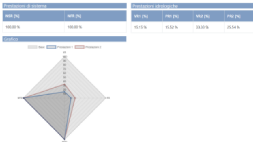
Figure 23: Performance du système (NSR - Network Stress Reduction et NFR - Node Flood Reduction), performance hydrologique (VR - Volume Reduction et PR - Peak Flow Reduction) et graphique radar correspondant dans le scénario "systèmes secs" pour le cas d'étude de Via Grazia Deledda objet de l'intervention COLANDER et pour l'événement du projet avec une période de retour de 2 ans.
