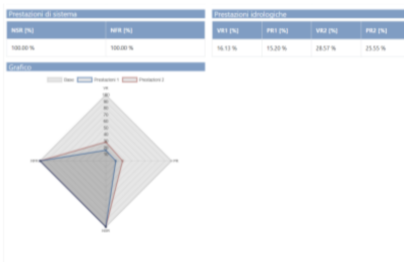
Figure 29: Performance du système (NSR - Network Stress Reduction et NFR - Node Flood Reduction), performance hydrologique (VR - Volume Reduction et PR - Peak Flow Reduction) et graphique radar correspondant dans le scénario "systèmes humides" pour le cas d'étude de Via Grazia Deledda objet de l'intervention COLANDER et pour l'événement du projet avec une période de retour de 10 ans.
