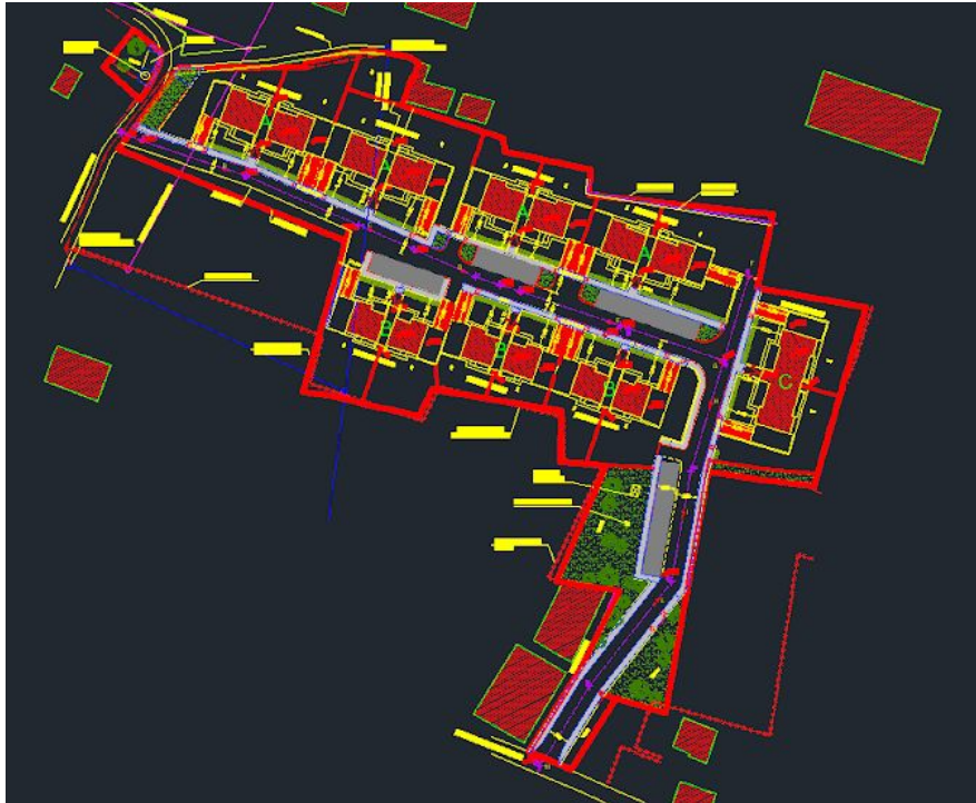
Figure 9: Extrait du plan général du projet, avec indications détaillées des bâtiments et des travaux accessoires pour le complexe résidentiel PEEP Bovalico.
