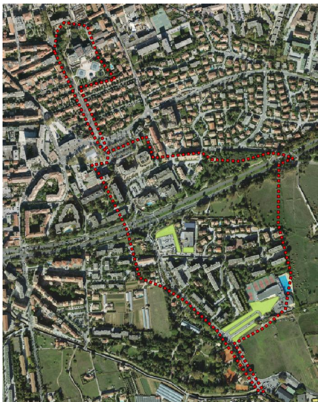
Figura 12: Restituzione nella piattaforma TRIG Eau del sistema di pavimentazioni permeabili (aree verdi) da realizzarsi nel bacino Est di Avenue Ambroise Thomas.
