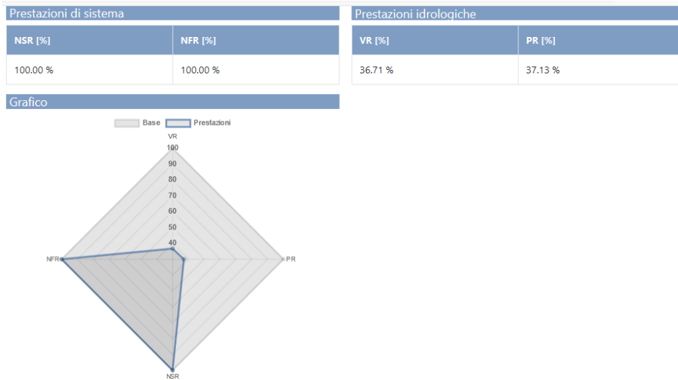
Figura 22: Prestazioni di sistema (NSR- Riduzione dello Stress della rete e NFR - Riduzione dell'allagamento nei nodi), prestazioni idrologiche (VR- riduzione del volume e PR- riduzione della portata di picco) e relativo grafico a radar nello scenario "4 Vasche - vuote" per il caso di studio di via Figari e per l'evento di progetto con periodo di ritorno pari a 5 anni.
