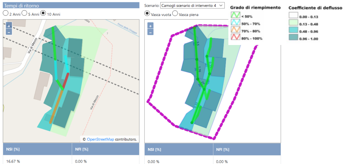
Figura 23: Mappa della condizione di rischio idraulico attuale (a sinistra) e di rischio residuo nello scenario "4 Vasche - vuote" (a destra) per il caso di studio di Via Figari ed indicatori della funzionalità della rete di drenaggi (NSI- Indice di Stress della Rete; NFI- Indice di Allagamento dei nodi) per l'evento di progetto con periodo di ritorno pari a 10 anni. In alto a sinistra è riportata la legenda degli elementi (grado di riempimento delle condotte e coefficiente di deflusso dei sottobacini) riportati nella mappa.
