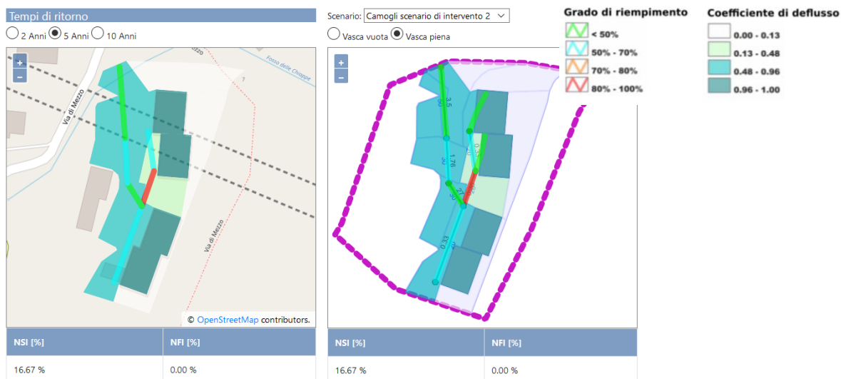
Figura 17: Mappa della condizione di rischio idraulico attuale (a sinistra) e di rischio residuo nello scenario "2 Vasche - piene" (a destra) per il caso di studio di Via Figari ed indicatori della funzionalità della rete di drenaggi (NSI- Indice di Stress della Rete ; NFI- Indice di Allagamento dei nodi) per l'evento di progetto con periodo di ritorno pari a 5 anni. In alto a sinistra è riportata la legenda degli elementi (grado di riempimento delle condotte e coefficiente di deflusso dei sottobacini) riportati nella mappa.
