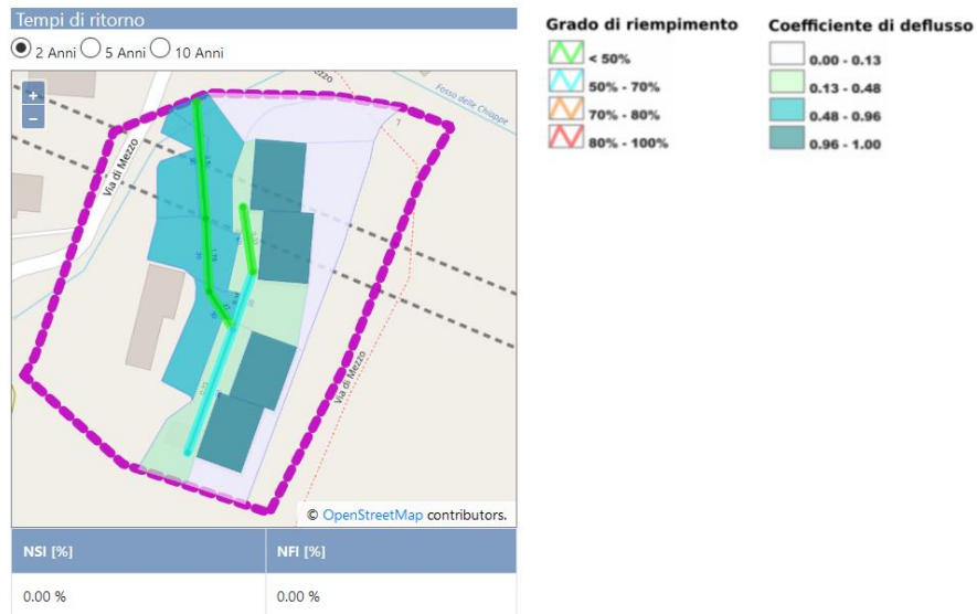
Figura 10: Mappa della condizione di rischio idraulico attuale per il caso di studio di Via Figari ed indicatori della funzionalità della rete di drenaggi (NSI- Indice di Stress della Rete; NFI- Indice di Allagamento dei nodi) per l'evento di progetto con periodo di ritorno pari a 2 anni. In alto a sinistra è riportata la legenda degli elementi (grado di riempimento delle condotte e coefficiente di deflusso dei sottobacini) riportati nella mappa.
