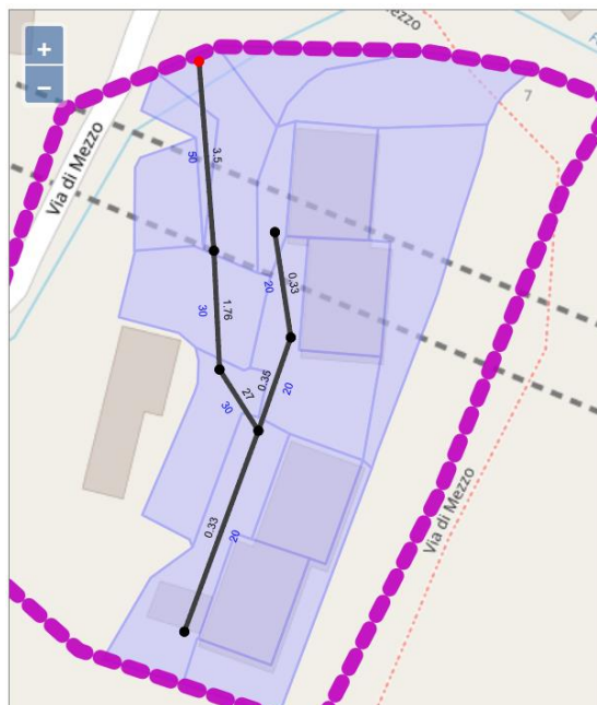
Figura 9: Implementazione nella piattaforma TRIG Eau del caso di studio di Via Figari. Indicazione dei sottobacini (poligoni azzurri) e della rete di drenaggio delle acque meteoriche (linea nera) comprensiva di valori dei diametri in cm (etichette blu) e delle pendenze (etichette nere) di ciascun ramo.
