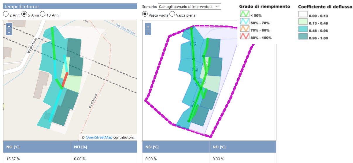
Figura 21: Mappa della condizione di rischio idraulico attuale (a sinistra) e di rischio residuo nello scenario "4 Vasche - vuote" (a destra) per il caso di studio di Via Figari ed indicatori della funzionalità della rete di drenaggi (NSI- Indice di Stress della Rete; NFI- Indice di Allagamento dei nodi) per l'evento di progetto con periodo di ritorno pari a 5 anni. In alto a sinistra è riportata la legenda degli elementi (grado di riempimento delle condotte e coefficiente di deflusso dei sottobacini) riportati nella mappa.
