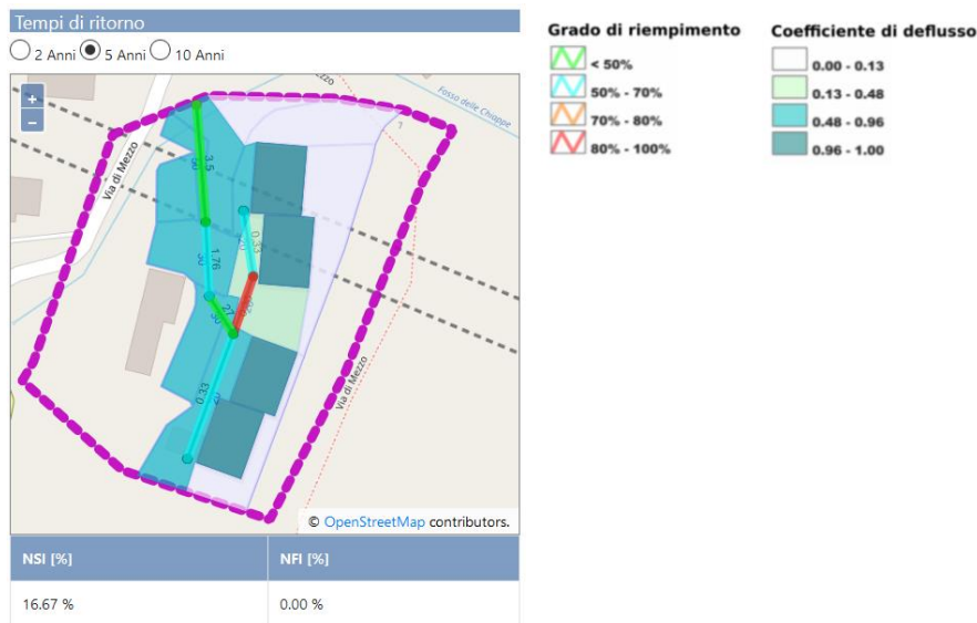
Figura 11: Mappa della condizione di rischio idraulico attuale per il caso di studio di Via Figari ed indicatori della funzionalità della rete di drenaggi (NSI- Indice di Stress della Rete; NFI- Indice di Allagamento dei nodi) per l'evento di progetto con periodo di ritorno pari a 5 anni. In alto a sinistra è riportata la legenda degli elementi (grado di riempimento delle condotte e coefficiente di deflusso dei sottobacini) riportati nella mappa.
