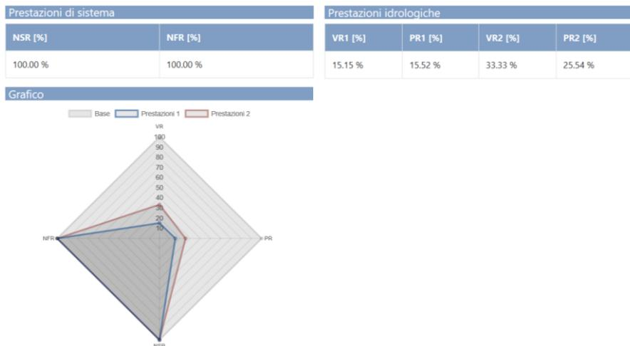
Figura 23: Prestazioni di sistema (NSR- Riduzione dello Stress della rete e NFR - Riduzione dell'allagamento nei nodi), prestazioni idrologiche (VR- riduzione del volume e PR- riduzione della portata di picco) e relativo grafico a radar nello scenario "Sistemi secchi" per il caso di studio di Via Grazia Deledda oggetto dell'intervento COLANDER e per l'evento di progetto con periodo di ritorno pari a 2 anni.
