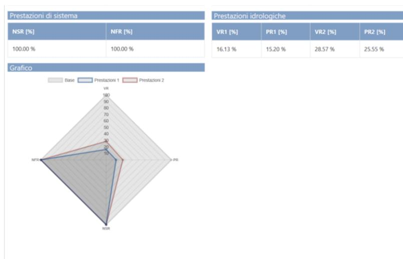
Figura 29: Prestazioni di sistema (NSR- Riduzione dello Stress della rete e NFR - Riduzione dell’allagamento nei nodi), prestazioni idrologiche (VR- riduzione del volume e PR- riduzione della portata di picco) e relativo grafico a radar nello scenario “Sistemi umidi” per il caso di studio di Via Grazia Deledda oggetto dell’intervento COLANDER e per l’evento di progetto con periodo di ritorno pari a 10 anni.
