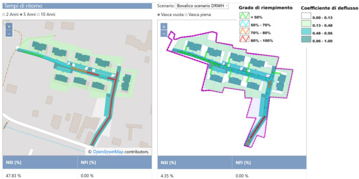
Figura 19: Mappa della condizione di rischio idraulico attuale (a sinistra) e di rischio residuo nello scenario "Vasche vuote" (a destra) per il caso pilota del PEEP-Bovalico ed indicatori della funzionalità della rete di drenaggi (NSI- Indice di Stress della Rete; NFI- Indice di Allagamento dei nodi) per l'evento di progetto con periodo di ritorno pari a 5 anni. In alto a sinistra è riportata la legenda degli elementi (grado di riempimento delle condotte e coefficiente di deflusso dei sottobacini) riportati nella mappa.
