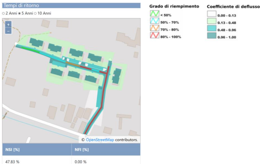
Figura 15: Mappa della condizione di rischio idraulico attuale per il caso pilota del PEEP-Bovalico ed indicatori della funzionalità della rete di drenaggi (NSI- Indice di Stress della Rete ; NFI- Indice di Allagamento dei nodi) per l'evento di progetto con periodo di ritorno pari a 5 anni. In alto a sinistra è riportata la legenda degli elementi (grado di riempimento delle condotte e coefficiente di deflusso dei sottobacini) riportati nella mappa.
